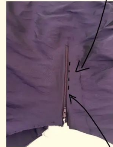
Stiro e fissaggio tramite applicazione di nastro termoadesivo, rifinito con impuntura di rinforzo superiore.
